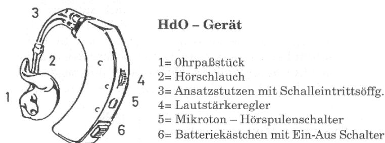
**Abb. 6: Aufbau eines HdO-Hörgerätes (nach Löwe 1992b, 90)**
