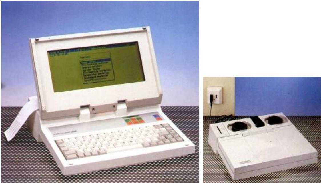
**Abbildung 15 (a,b) – modernes Schreibtelefon mit Akustikkoppler und eingebautem Drucker**
