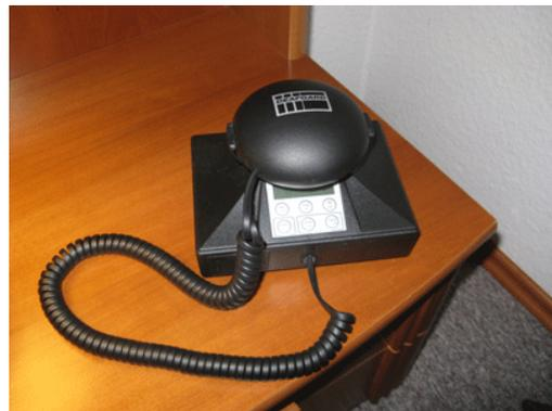
Wie funktioniert DEAFGARD? Wenn ein Schwelbrand im Gebäude ausbricht und der Rauch in den Rauchmelder eindringt, wird ein akustischer Alarm (ab 75 dB) ausgelöst. Nach 15 bis 20 Sekunden reagiert dann DEAFGARD und schaltet die Blitzlampe und den Vibrator ein. Somit wird gewährleistet, dass der Hörgeschädigte aus dem Schlaf „gerissen“ wird und somit bei Feuer schnell die Flucht ergreifen kann.
